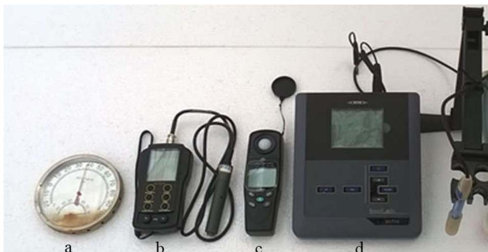
Hình 2.2. Một số thiết bị sử dụng trong thí nghiệm a) máy đo nhiệt độ và âm độ; b) máy đo EC; c) máy đo cường độ ánh sáng; và d) máy đo pH
